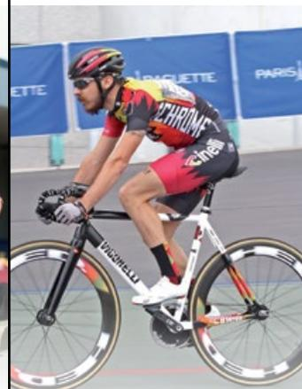
Geometria ad angoli acuti per cambi di traiettoria nervosi. La scatola del movimento è rialzata per non toccare col pedale nelle ripide curve dei velodromi. Il telaio compatto senza dispersioni garantisce la massima potenza alla ruota posteriore.
