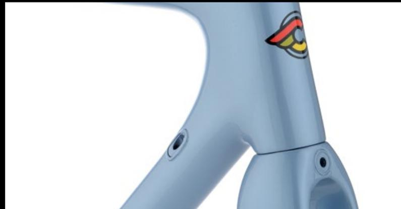
Il passaggio dei cavi è completamente interno sia per i gruppi meccanici che elettronici. Sterzo 1-1/8" e scatola movimento BSA.
